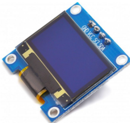
Рис. 1.3.2 - Вигляд OLED-дисплея SSD1306 (128×64)
