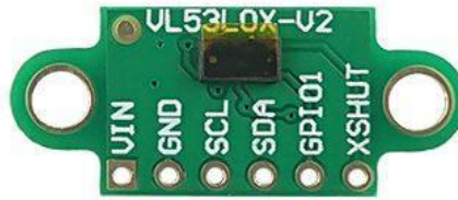
Рис. 1.3.1 - Вигляд лазерного датчика відстані VL53L0X
