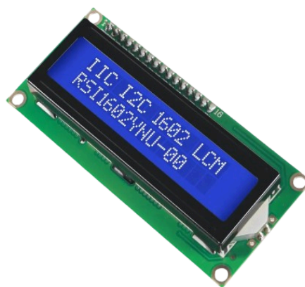
Рис 1.3. Вигляд рідкокристалічного дисплею (LCD 1602) з I2C
